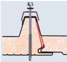
CAPPELLOTTO CON GUARNIZIONE PER IL FISSAGGIO DI COPERTURE GRECATE.
